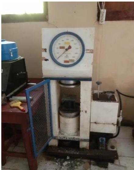
Gambar 3. Set Up Alat Uji Kuat Tekan
