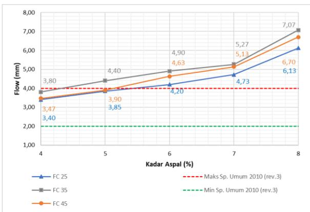
Gambar 7. Grafik pengaruh mutu agregat limbah beton dan kadar aspal terhadap flow
