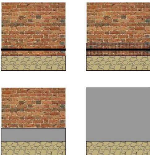
Gambar 1. Proses perkuatan sloof
