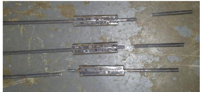
Gambar 7 Hasil pengujian tarik benda uji variasi sambungan 12 cm
