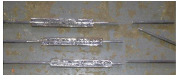
Gambar 9 Hasil pengujian tarik benda uji variasi sambungan 20 cm
