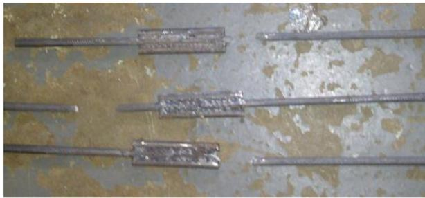
Gambar 6 Hasil pengujian tarik benda uji variasi sambungan 10 cm
