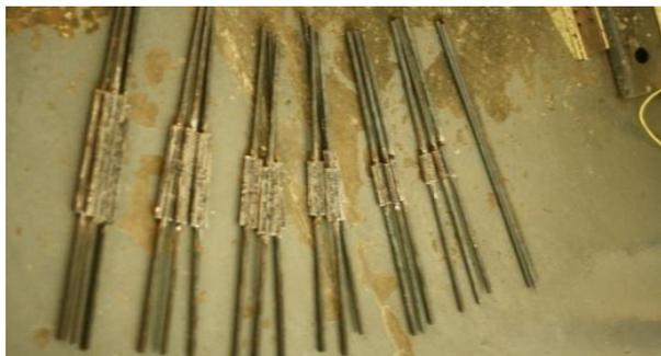
Gambar 2. Benda uji dengan variasi panjang pengelasan
