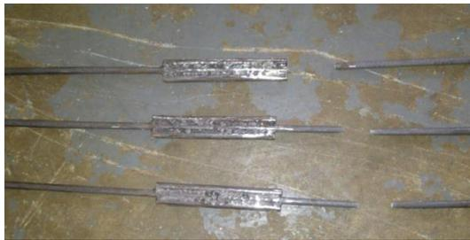
Gambar 8 Hasil pengujian tarik baja benda uji variasi panjang sambungan 16 cm
