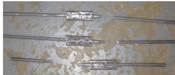
Gambar 5 Hasil pengujian tarik benda uji variasi sambungan 8 cm
