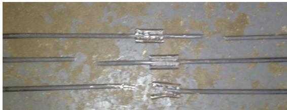
Gambar 4 Hasil pengujian tarik benda uji variasi sambungan 6 cm
