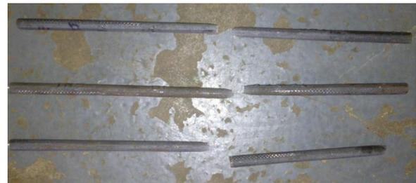
Gambar 3 Hasil pengujian tarik benda uji tanpa sambungan
