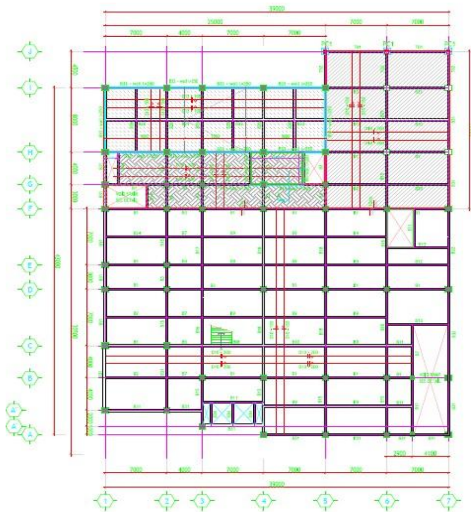
Gambar Denah Gedung Tanpa Shear Wall
