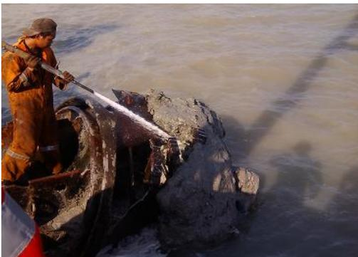
Dengan kondisi material seperti ini Kapal Keruk CSD yang cocok adalah yang menggunakan Cutterhead khusus, yaitu Cutter Wheel Suction atau Clay Cutter Head dengan kemampuan pompa yang kuat.
