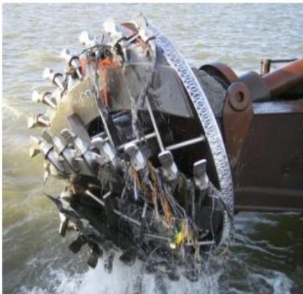
Ini berhubungan juga dengan Daya Pompa kapal keruk CSD. Jika yang dikeruk material keras dan menggunakan Cutterhead biasa, maka akan terjadi penurunan produksi. CSD yang digunakan harus sesuai dengan N-Value material dan Cutter Headnya juga harus sesuai dengan jenis material.
