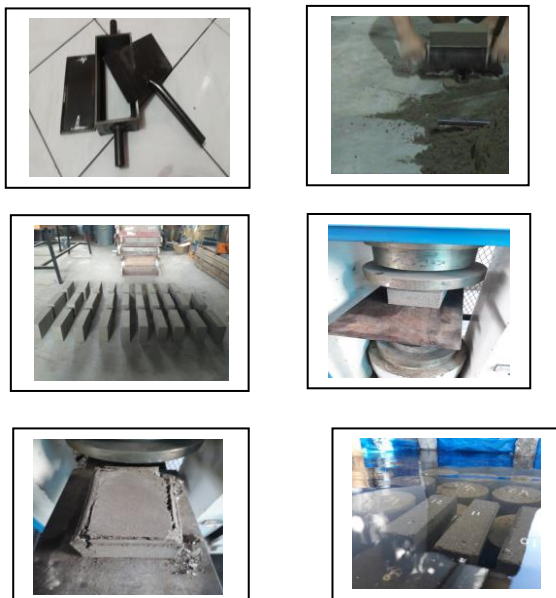
Gambar 2. Pencetakan Benda Uji dan Pengujian Kuat Tekan, Penyerapan Air Paving Block
