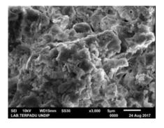
Gambar 4. SEM benda uji tanah gambut asli
