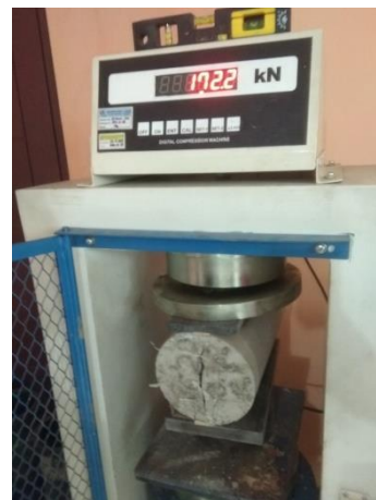
Gambar 4. Pengujian kuat tarik belah beton
