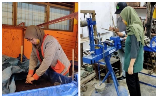
Gambar 3. Uji Kuat Geser: (a) Cetak sampel; (b) Proses uji geser langsung
