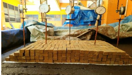
Gambar 2. Proses Preloading dengan Timbunan Besi
