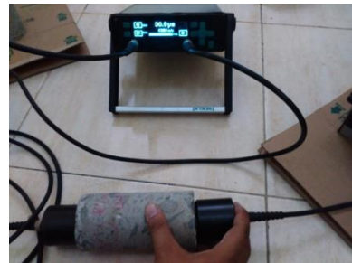
Gambar 10. uji UPV direct methods pada Sample CD
