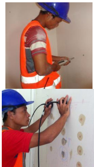
Gambar 8. Dokumentasi pengujian CH (kiri) dan UPV indirect methods (kanan)
