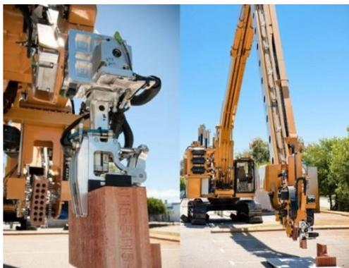
Gambar 7. Bentuk robot "Hadrian" yang dikembangkan oleh Fastbrick Robotics [44]
