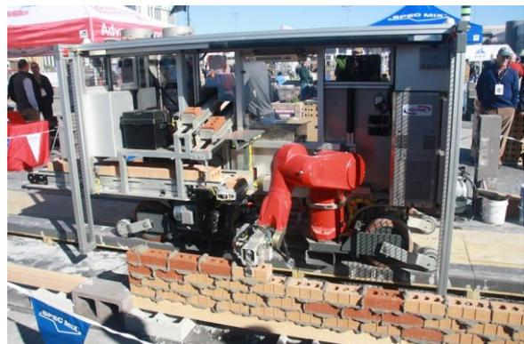
Gambar 8. Bentuk robot "SAM" (semi-automated mason) yang dikembangkan oleh Construction Robotics [45]
