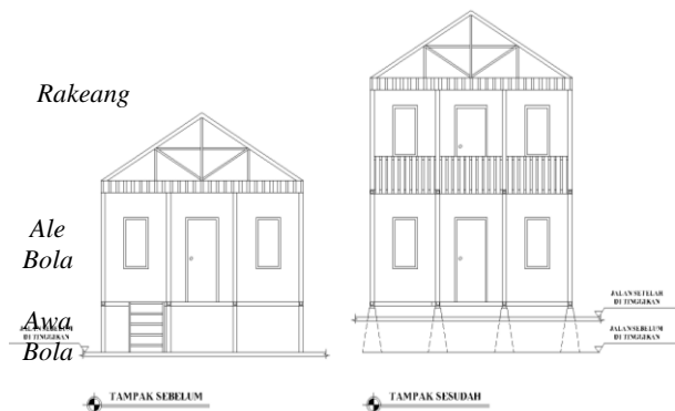
Gambar 8. Tampak Bangunan Rumah A sebelum perubahan (kiri) dan sesudah perubahan (kanan)
