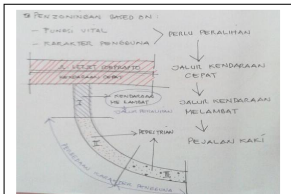
Gambar 17: Gambar di atas menunjukkan bagaimana desain jalur pedestrian yang diusulkan dapat mengakomodasi kebutuhan pengguna dengan membaginya menjadi 3 zona utama. (Sumber: Hasil Analisa, 2014)
