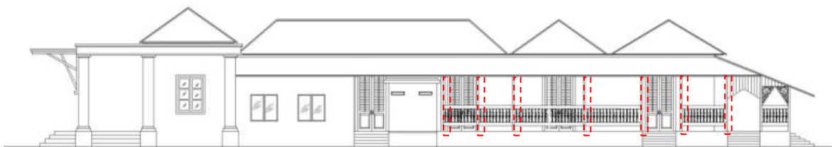
Gambar 10. Kolom kayu pada sepanjang serambi bangunan Sumber: Dokumentasi Pribadi, 2014
