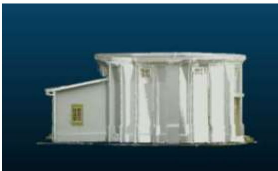
Gambar 3. Hasil Model 3D Bangunan Observatorium Bosscha Secara Meshing dengan Octre Depth 10 dan Kkn 10.
