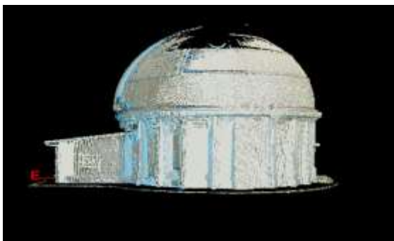
Gambar 2. Hasil Model 3D Bangunan Observatorium Bosscha Secara Point cloud
