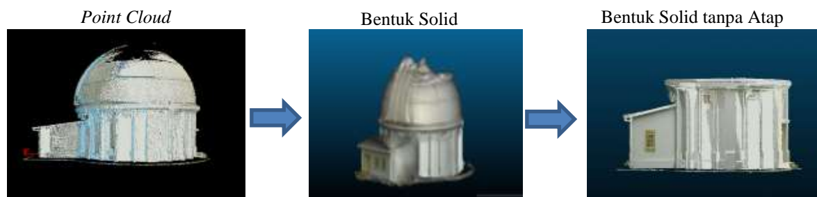
Gambar 7. Ilustrasi Perubahan Data Dari Point Cloud Menjadi Bentuk Yang Solid
