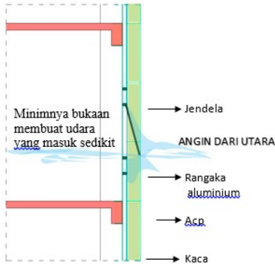
Gambar 8: detail potongan bukaan (Sumber: Analisa peneliti 2020)
