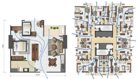
Gambar 4.1.4 Penerapan sistem cross ventilation Sumber: (Analisa Pribadi, 2020)
