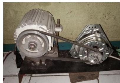
Gambar 3. Motor listrik jenis kapasitor satu fasa dengan beban generator arus searah.
