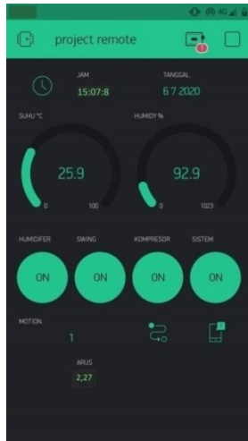
Gambar 4 Pengukuran Suhu dan Kelembaban menggunakan Sensor DHT 22
