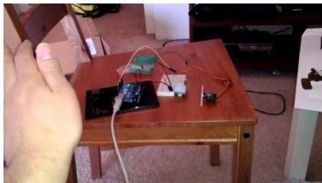
Gambar 14 Sensor PIR dan Motor servo mendeteksi adanya pergerakan
