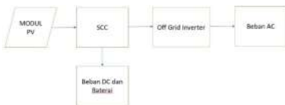
Gambar 5. Skema Off-Grid secara umum
