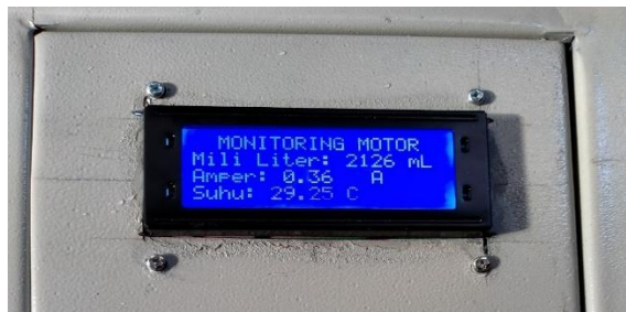
Gambar 5. Hasil pembacaan suhu pada layar lcd panel box.
