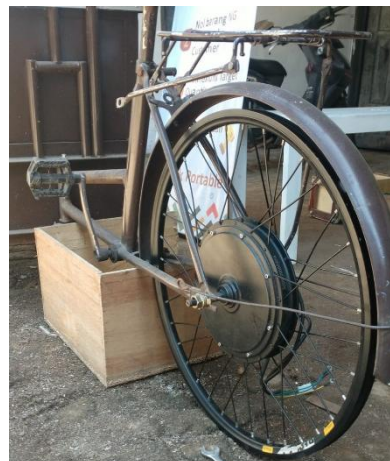
Gambar 6. Pemasangan Motor pada Roda Gerobak
