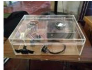
Gambar 9. Alat Pengaduk Magnetik, Alarm Pemanas dan Sensor Warna
