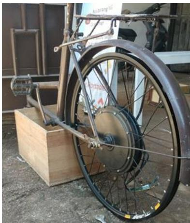
Gambar 6. Pemasangan motor brushless DC pada gerobak listrik.
