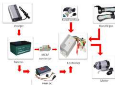
Gambar 5. Wiring motor listrik dengan PWM DC
