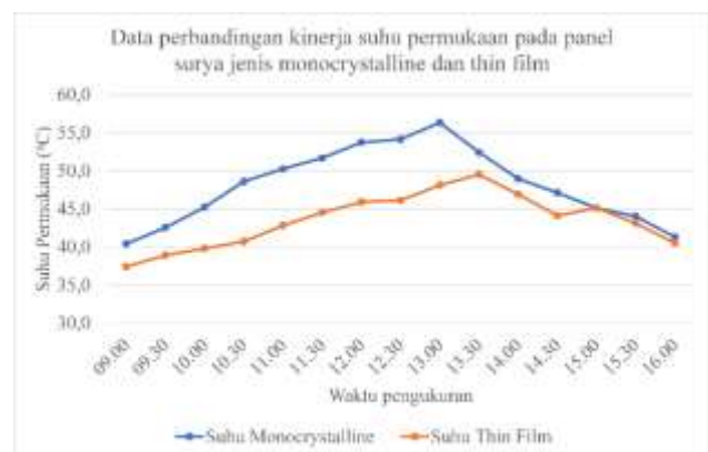
Gambar 6. Grafik perbandingan kinerja suhu permukaan panel surya jenis monocrystalline dan thin film dengan pencahayaan sinar matahari langsung
