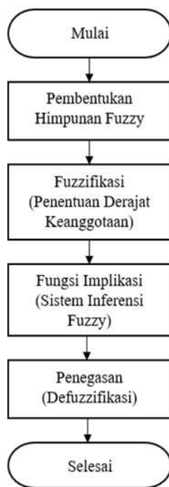
Gambar 3. Perancangan sistem kendali fuzzy
