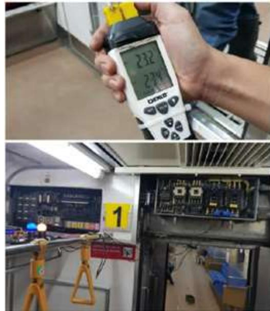
Gambar 13. Pengujian sensor suhu DS18B20.
