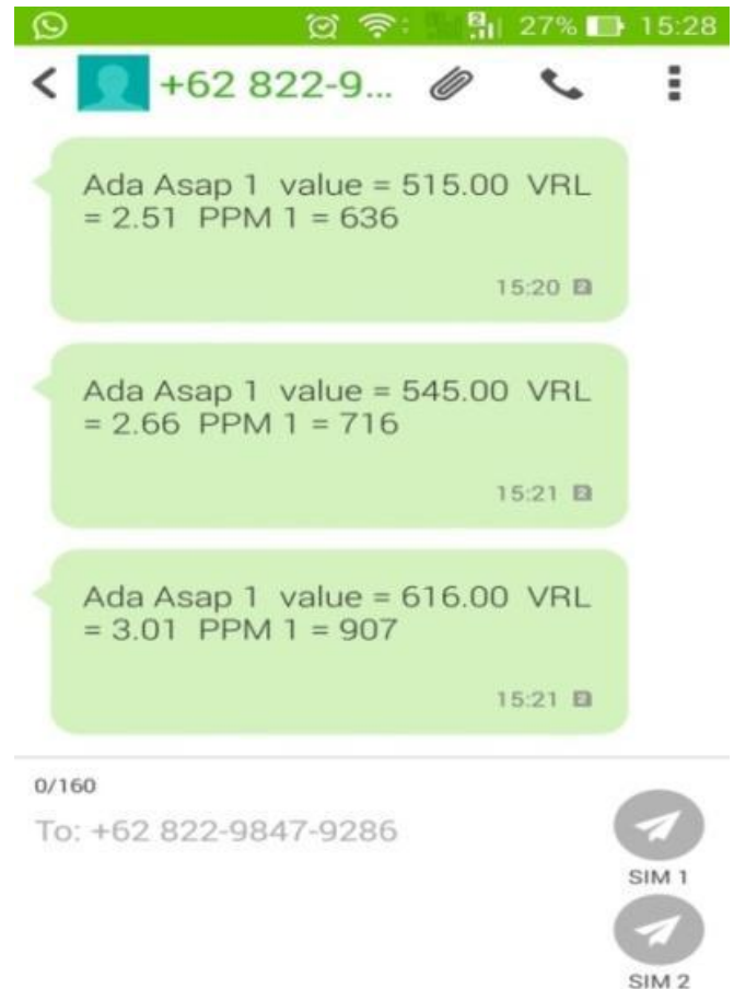
Gambar 18 Tampilan SMS deteksi asap pada sensor MQ-7 (1).
