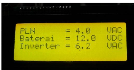
Gambar 6. Sensor tegangan DC mendeteksi adanya tegangan pada baterai atau aki.
