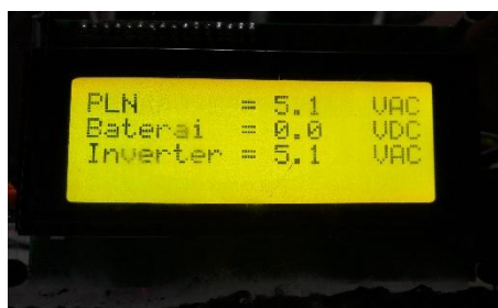
Gambar 5. Sensor tidak mendeteksi adanya tegangan dari pln maupun dari energi alternatif.
