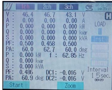
Gambar 5 Pengukuran tegangan menggunakan alat ukur power quality analyzer
