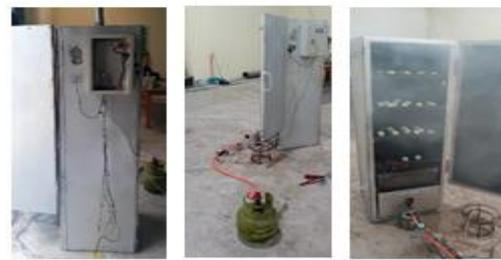
**Gambar 2.** Proses pembuatan dan uji coba lemari asap terkontrol
