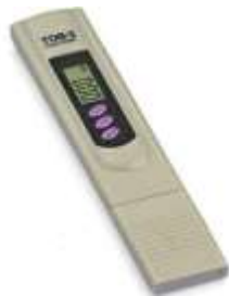
Gambar 12 TDS meter merupakan sebuah instrument pengukur kadar zat terlaru
