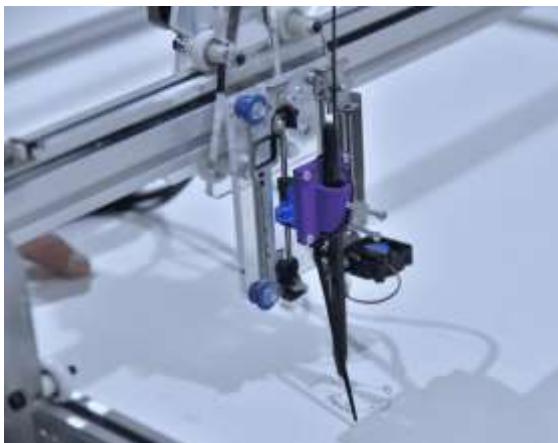
Gambar 5. Proses Pembuatan Pola Batik Menggunakan Mesin Batik Tulis
