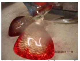
Gambar 5. Penetrant pada daun propeller
