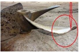
Gambar 2. Baling- Baling kapal yang bengkok
