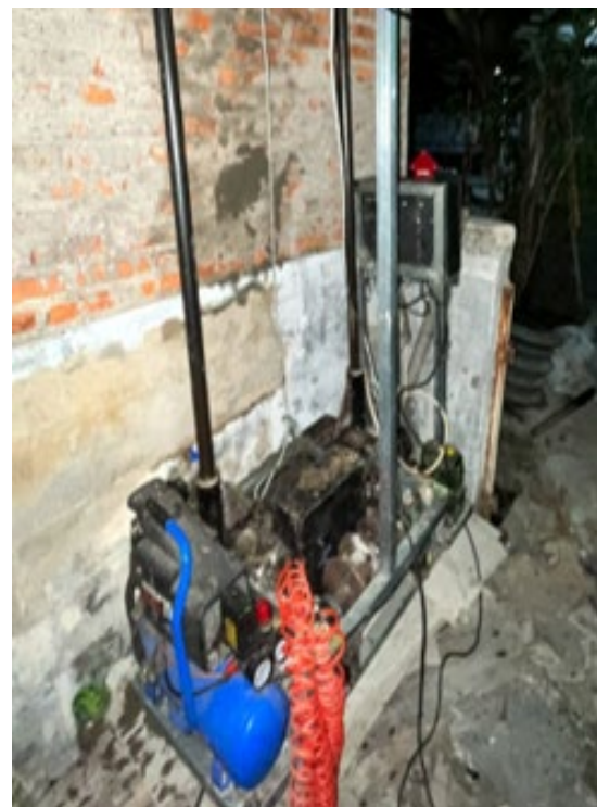
Gambar 2. Uji Coba Mesin Plester Tembok
