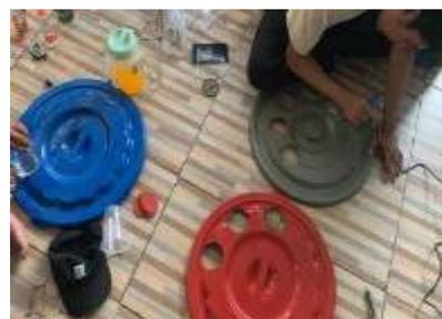
**Gambar 4.** Proses Pembuatan Lubang Tutup Ember
