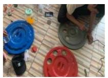
**Gambar 4.** Proses Pembuatan Lubang Tutup Ember
