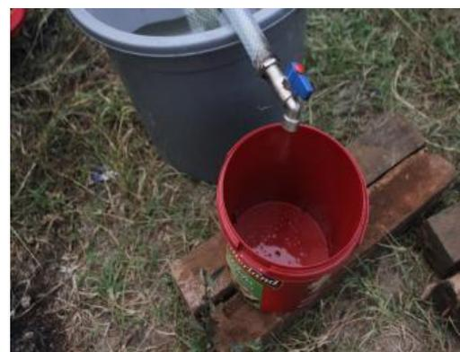
Gambar 5. Proses penampungan embun dari hasil penguapan berupa cairan mentah BBM
