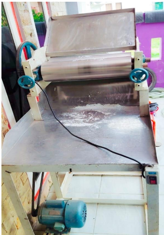
Gambar 2. Mesin Pengulen dan Penghalus Adonan
