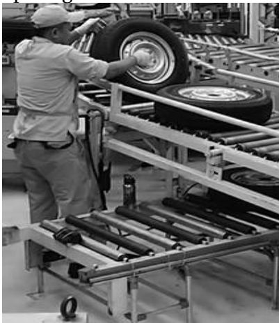
Gambar 1. Postur dan cara kerja pekerja perakitan pos roda mobil
