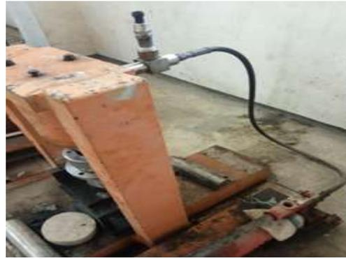
**Gambar 10.** Sensor *Pressure Transmitter* 100 Bar yang terhubung ke alat CTM (*Compression Testing Machines*)
