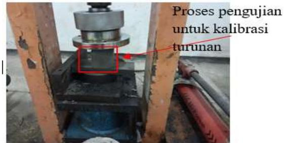
**Gambar 14.** Proses pengujian bahan uji untuk kalibrasi turunan pada mesin *Compression Testing Machines* (CTM)
