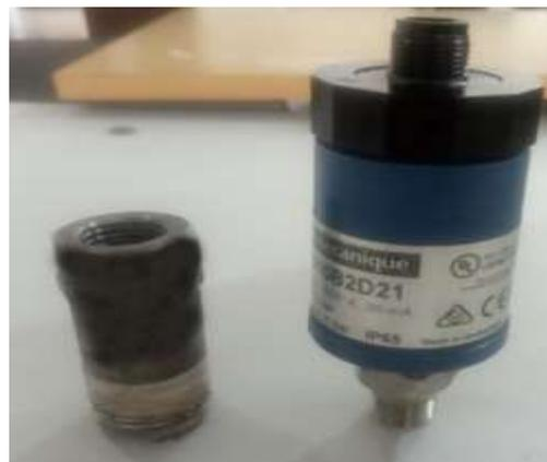
**Gambar 7.** *Interface* penghubung dan Sensor *Pressure Transmitter*
