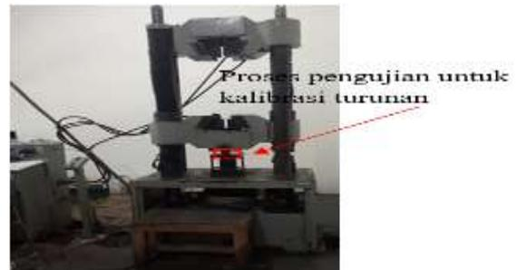
**Gambar 15.** Proses pengujian bahan uji untuk kalibrasi turunan pada mesin *Universal Testing machine* (UTM)
