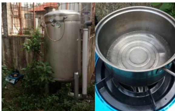
Gambar 6 Uji pembakaran Biogas
