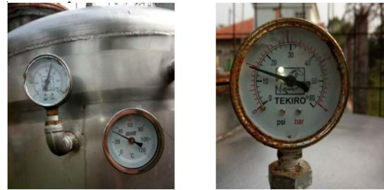
Gambar 4. Pengukuran tekanan dan temperatur biogas
