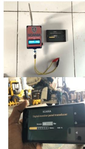
Gambar 15 Proses pembacaan hasil pengukuran setelah dilakukan perbaikan
