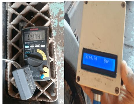
Gambar 13 Perbandingan Pengukuran Tool Avometer dengan Tool Modifikasi
