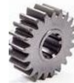
Gambar 4 hasil cetakan roda gigi dengan komposisi penambahan 40 %
