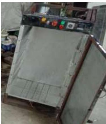
Gambar 3 Alat pengering ikan asin dengan sumber energi hybrid
