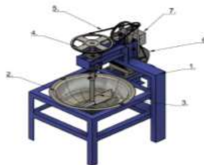
Gambar 2. Mesin Pengaduk Adonan Bakso
