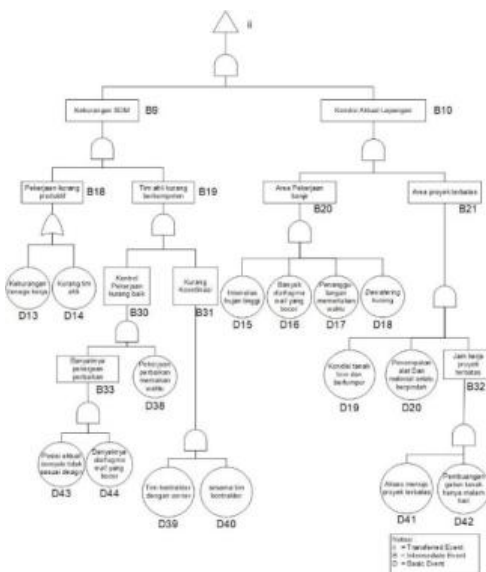
Gambar 7. Penamaan grafis Fault Tree Analysis Pekerjaan Basement (B1 - B6) pada Event Manajemen Pelaksanaan Pekerjaan
