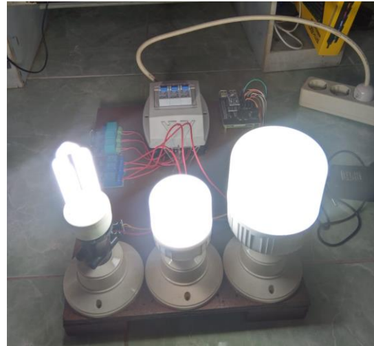
Gambar 7. Pengujian Lampu Aktif pada phase R,S,T
