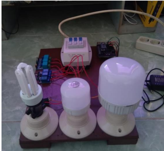
Gambar 9. Pengujian Lampu Tidak Aktif Pada Phase R, S, dan T
