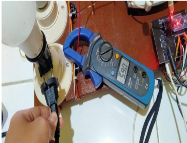
Gambar 5. Pengujian Phase R,S,T dengan beban Hotgun 1500 watt
