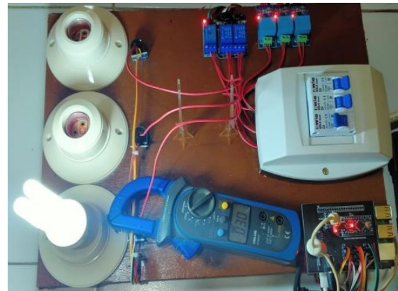
Gambar 3. Percobaan phase R,S,T dengan tang ampere
